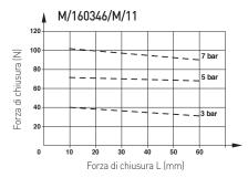
Forza effettiva di bloccaggio in chiusura = forza teorica di bloccaggio in chiusura x 0,85
